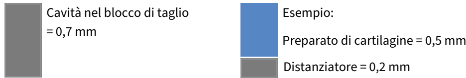
Fig. 3: Spessore del preparato di cartilagine = 0,7 mm meno lo spessore dei distanziatori
